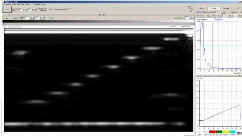
Рис. 9: Изображение В-сканирования, полученное с помощью зонда частотой 1 МГц, время измерения 10 секунд, изображение не обработано.
