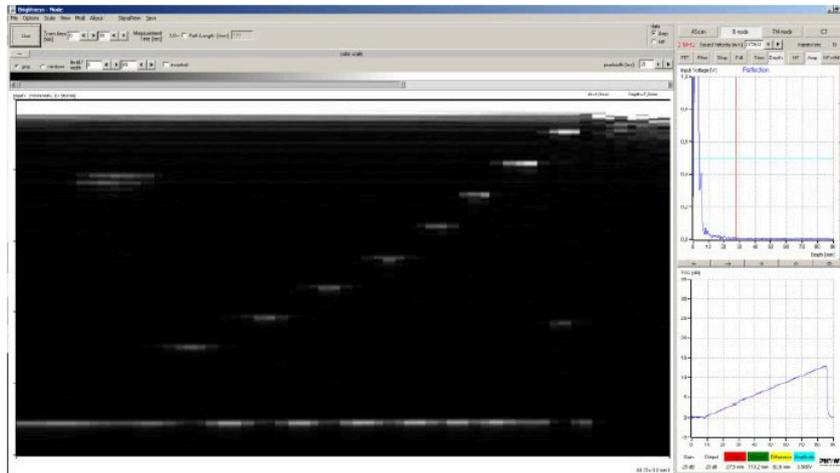
Рис. 12: В-сканированное изображение, полученное при нерегулярном движении датчика.
