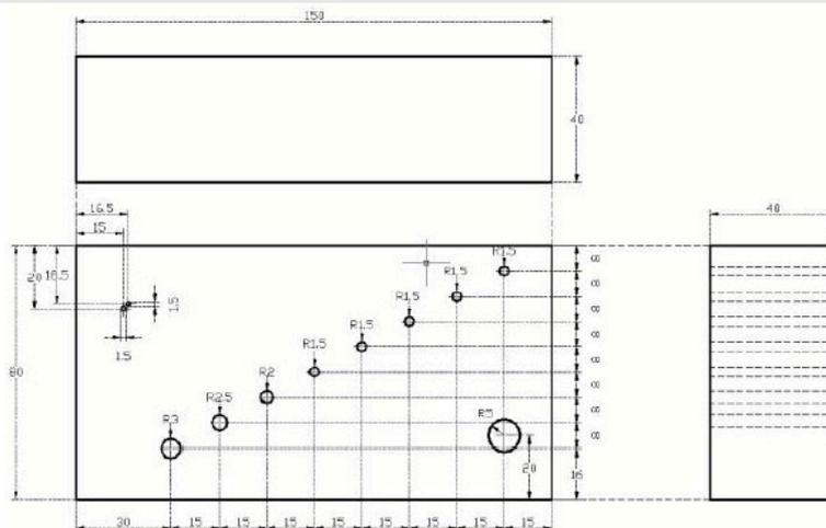
Рис. 2: Технический чертеж исследуемого блока ультразвукового контроля
