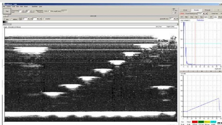
Рис. 11: Изображение В-сканирования с сильно превышающим сигналом
