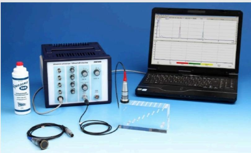
Рис. 1: Оборудование для ультразвуковой эхографии, экспериментальная установка
